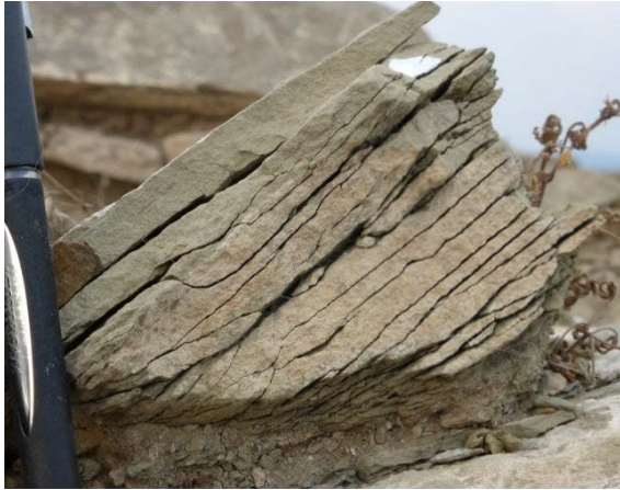
Слика 11: Оштетување на песочник
